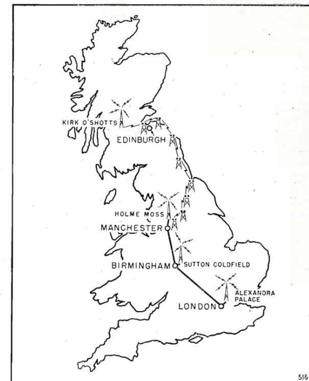
Fig. 2. — Carta geografica che illustra la rete di ponti radio della televisione britannica attualmente in fase di completamento.
